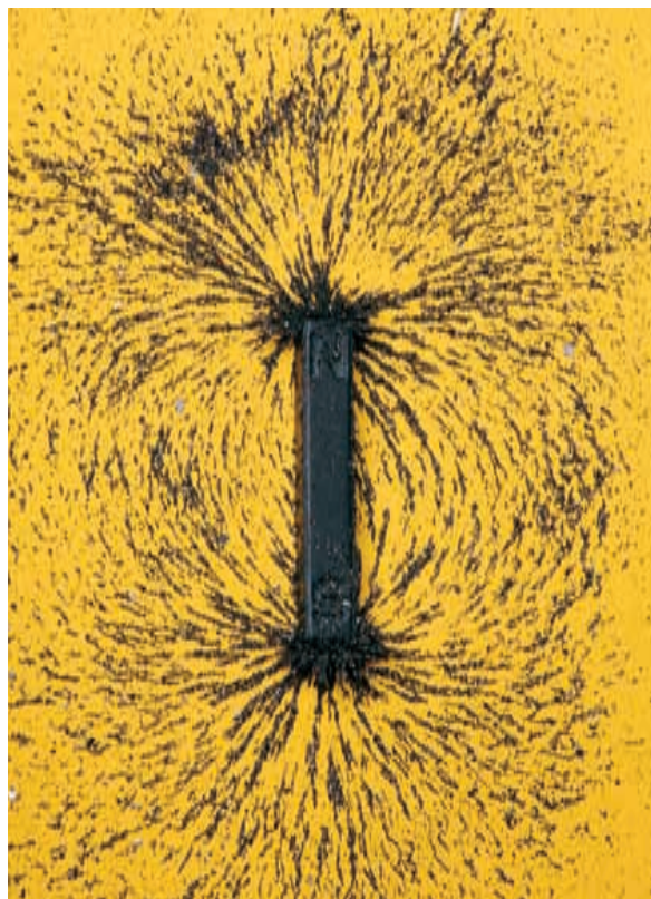
Limadura de hierro orientada alrededor de los polos del imán. El campo magnético fluye en curvas y la limadura se alinea con él.
