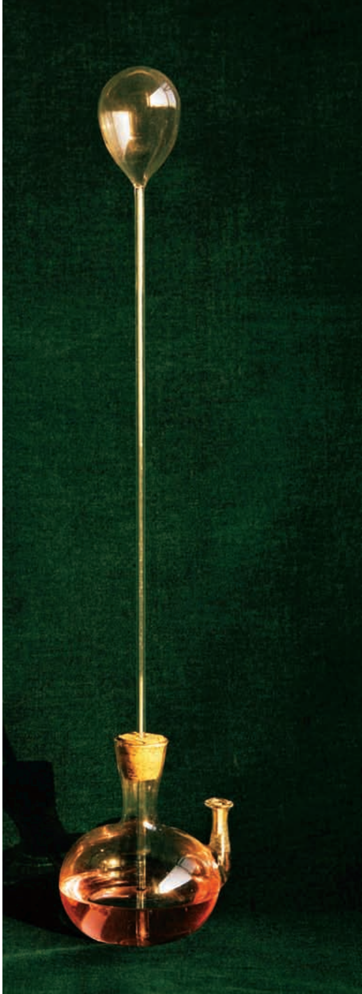
Termoscopio inventado por Galileo Galilei.
